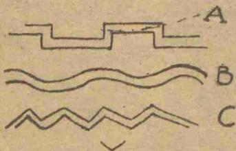
gún sea la clase de trinchera que tengamos que hacer. Estas pueden ser de tres clases: cremallera (A), ondulada (B) y en zigzag (C).
