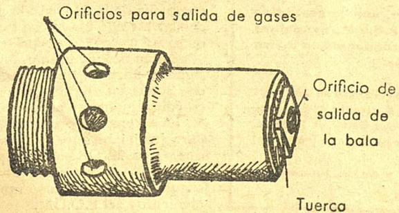
ra y rodeando al orificio de salida de la bala hay una tuerca. Dicha caja se ajusta a rosca con el tubo de refrigeración.
