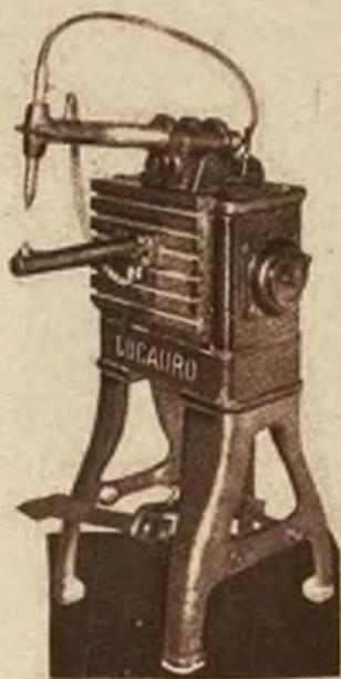
Máquina de soldar por puntos
