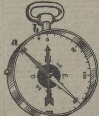
FIG. 16 A. punta de la aguja imantada. B. flecha indicadora de la dirección
