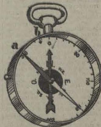
FIG. 16 A. punta de la aguja imantada. B. flecha indicadora de la dirección
