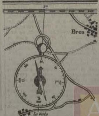
FIG. 17 Plano orientado por medio de la brújula
