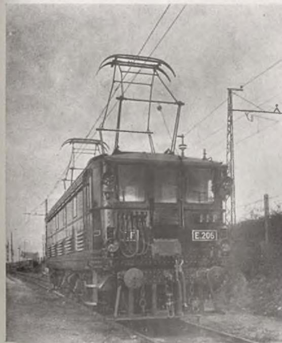
Locomotora eléctrica G. E. 3.000 v. 1.620 C. V.
